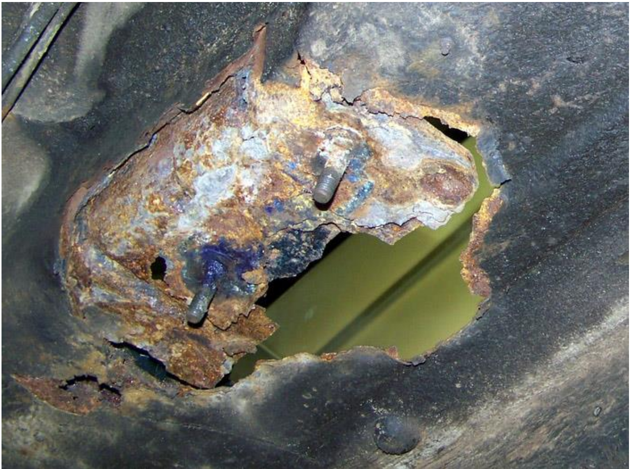
Рис. 2.1.3 Сквозная коррозия днища
