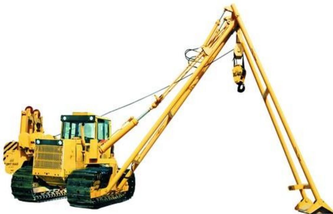
Рисунок 8 – Трубоукладчик со стрелой опорой ТБ-4
