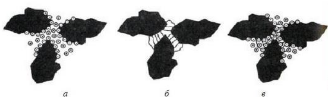
Рисунок 5 – Механизм действия добавок в ВУТ: а и б – диспергирование за счет электростатических сил отталкивания и образования стерического барьера, в – комбинированное воздействие механизмов а и б.
