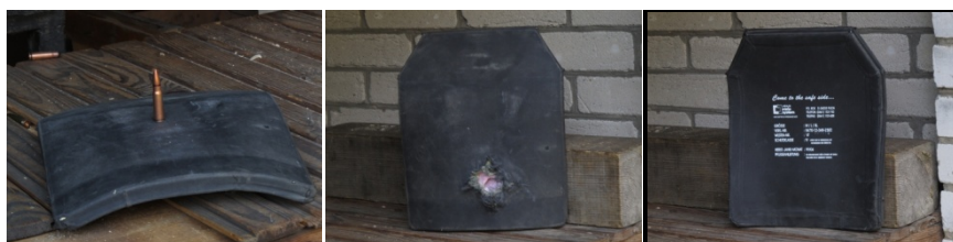
Рис. 2. Бронеплита керамическая SK4 MehlerVarioSystem [6]
