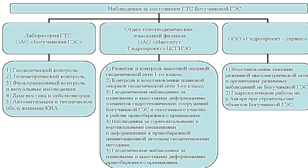
Рис. 1. Схема мониторинга за состоянием ГТС Богучанской ГЭС
