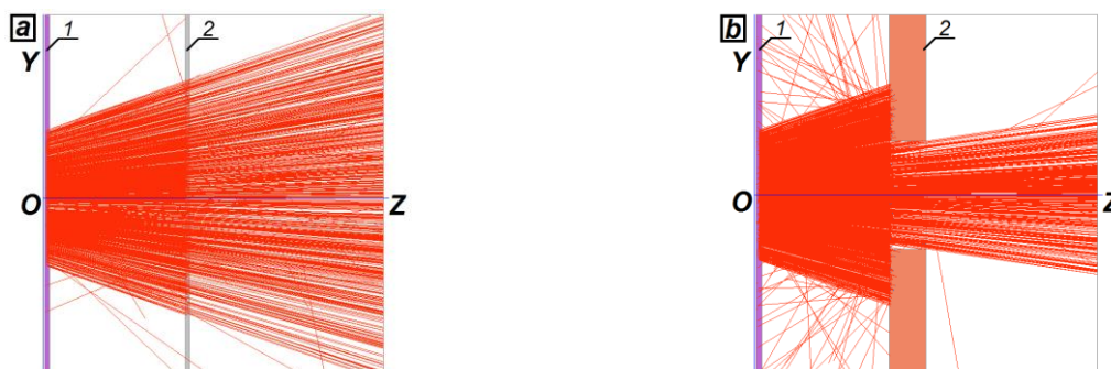
Рис. 1. Расчетная геометрия: а – неколлимированный рентгеновский пучок (1 – выходное окно; 2 – алюминиевый фильтр); б – коллимированный рентгеновский пучок (1 – выходное окно; 2 – коллиматор).
