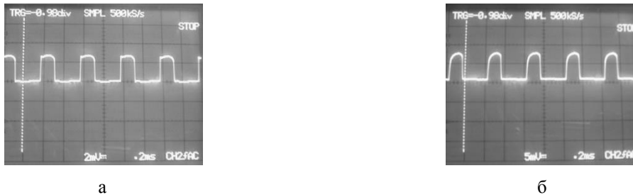
Рис. 3. Осциллограммы униполярных импульсов тока при процессе ЭХФ: а – R_{zcp} = 8,7 мкм, \tau = 3 мин, i_{a\text{имп}} = 1,8 А/см 2 , t_{\text{имп}} = 100 мкс, без перемешивания электролита, поверхность матовая; б – R_{zcp} = 10,5 мкм, \tau = 4 мин, i_{a\text{имп}} = 4,7 А/см 2 , t_{\text{имп}} = 100 мкс, перемешивание электролита, поверхность блестящая
