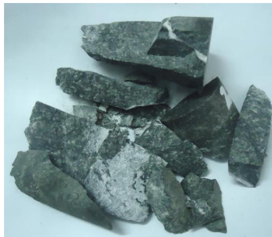
Рисунок 2 – Образцы разрушенной горной породы слева №23 (а) и справа №27 (б)
