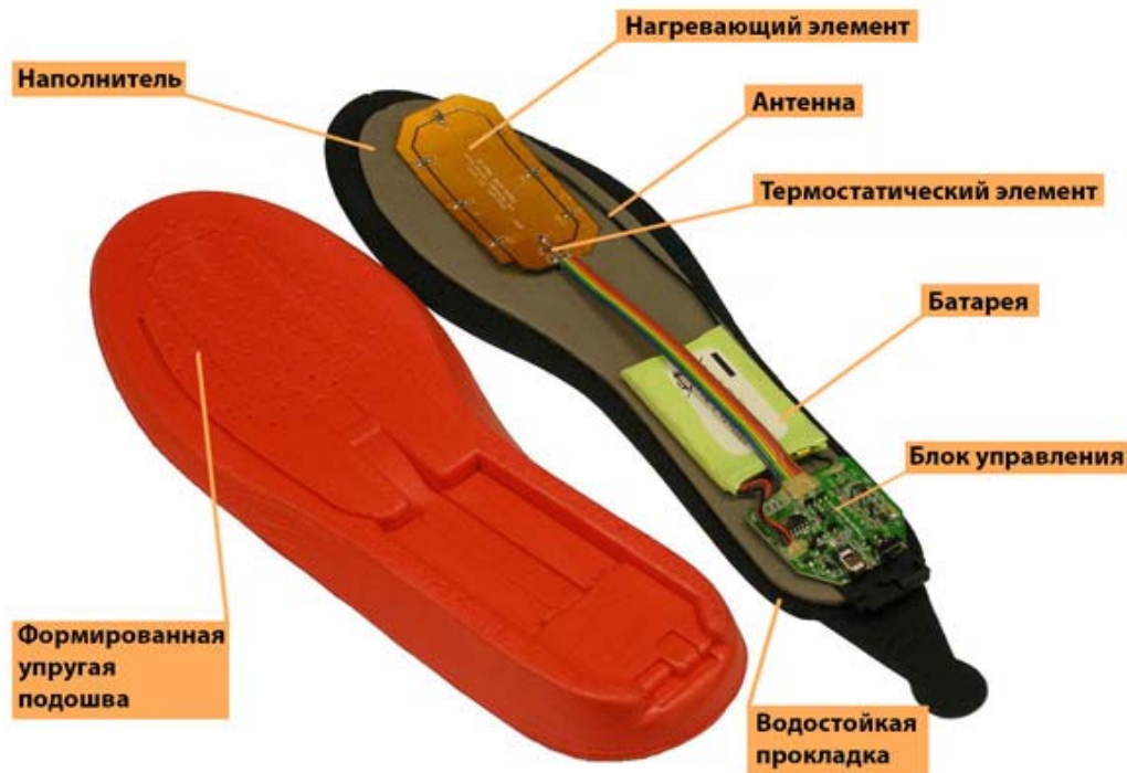
Рисунок 1. Схема стельки с подогревом
