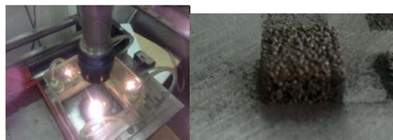
Рис. 1. Спекание порошка по SLS-технологии
