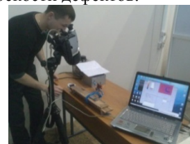
Рисунок 3. Проведение индукционной инфракрасной термографии.
