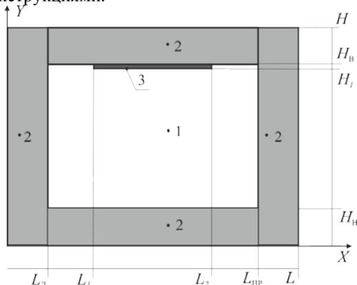
**Рис. 1.** Область решения рассматриваемой задачи: 1 – воздух; 2 – ограждающие конструкции; 3 – инфракрасный излучатель.
