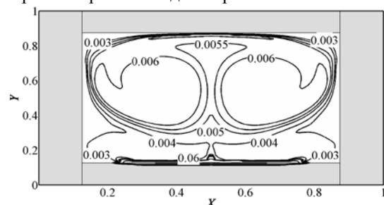
Рис. 3. Поле температур для модели естественной конвекции в замкнутой области для второго варианта модели при  $\tau=54000$ .
