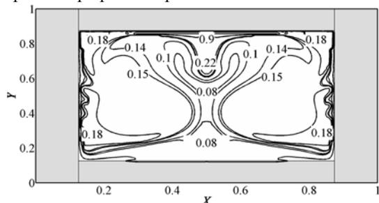
Рис. 2. Поле температур для условий естественной конвекции в замкнутой области для первого варианта модели при  $\tau=54000$ .
