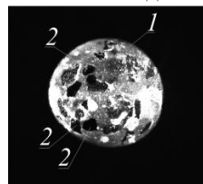
Рис. 2. Видеограмма капли воды ( R_d=3 мм) с примесью углеродистых частиц ( L_m = 450 \div 500 мкм): 1 – капля, 2 – углеродистые частицы
