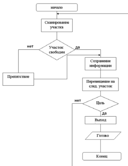
Рис. 2. Алгоритм движения робота в неизвестной среде Мобильная платформа
