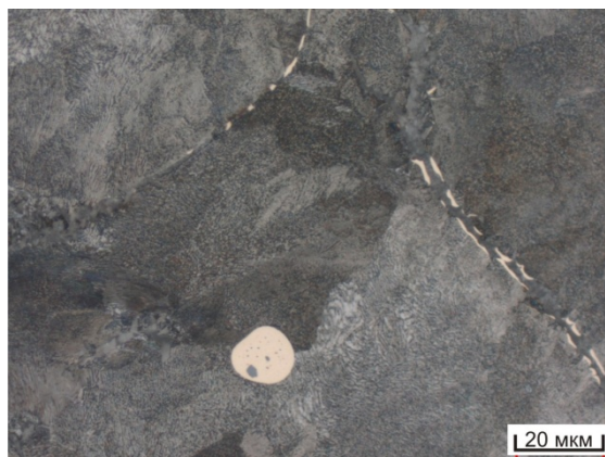
Рис. 2 – Структура графитизированной заэвтектоидной стали, содержащей 8,76 % Cu и 1,2 % Al
