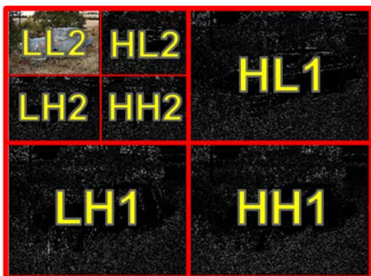
Рис. 3. Вейвлет-плоскости (LL – низкие частоты по строкам и столбцам; HL – высокие частоты по строкам и низкие по столбцам; LH – низкие частоты по строкам и высокие по столбцам; HH – высокие частоты по строкам и столбцам)
