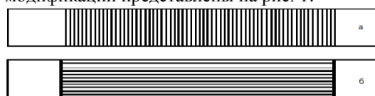
Рис. 1. Схемы с поперечным (а) и продольным (б) структурированием поверхности
