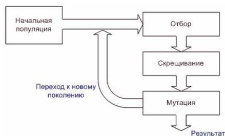
Рис. 2. Схема работы генетического алгоритма
