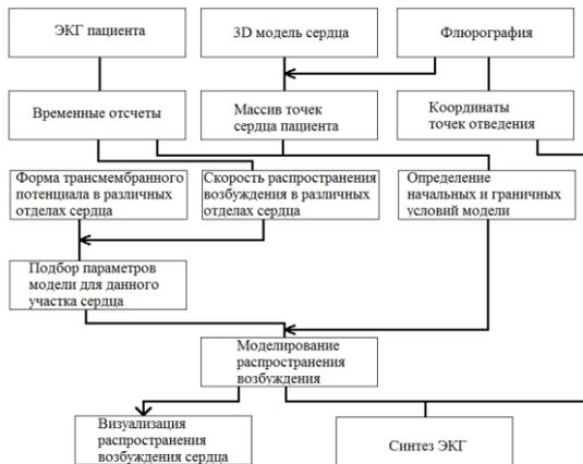
Рис.3. Алгоритм моделирования процесса распространения возбуждения в сердце
