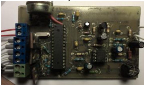
Рис. 5. ЦМУ после сборки (без корпуса). Заключительный этап создания ЦМУ написание и запись программы на контроллер. Для
