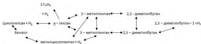
Рис. 1. Модельная схема превращения гексана на цеолитах
