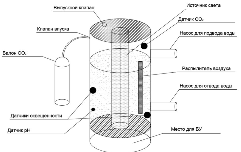
Рисунок 1. Конструкция культиватора
