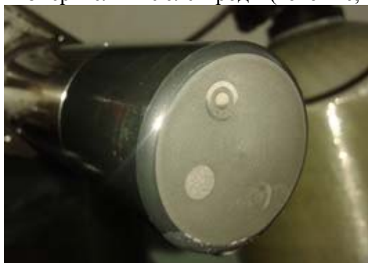
Рисунок 5 – Фотография датчика TetraCon 700 IQ
