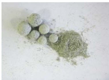
Рис.3. Шарики шаровой мельницы с образовавшимся на них покрытием
