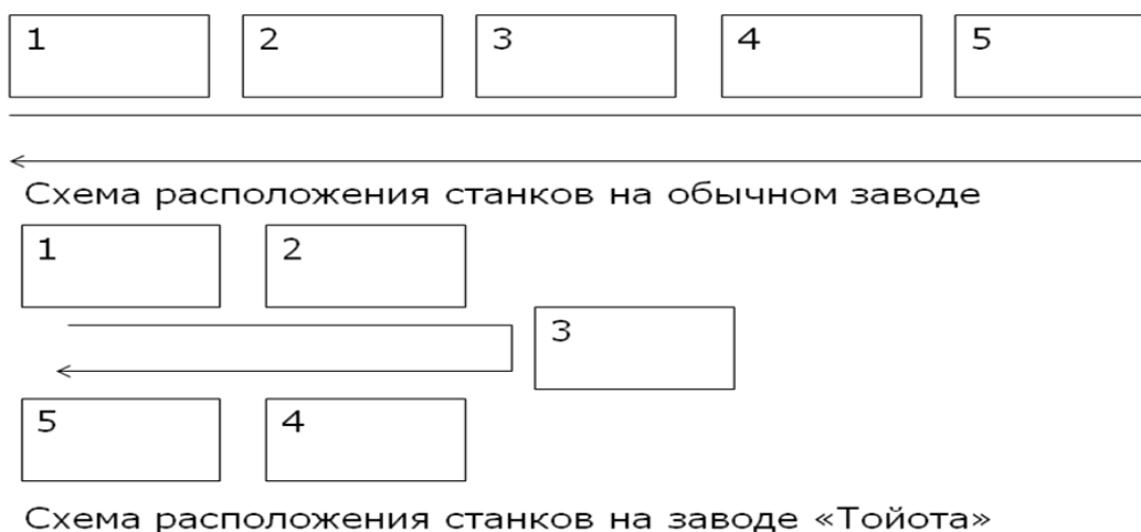
Рис. 2. Схемы эффективного и неэффективного расположения оборудования
