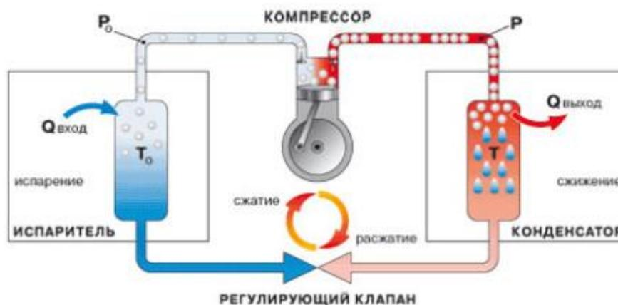
Рис. 1. Схема теплового насоса
