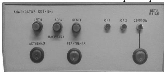
Рис. 3. Анализатор количества и качества электроэнергии
