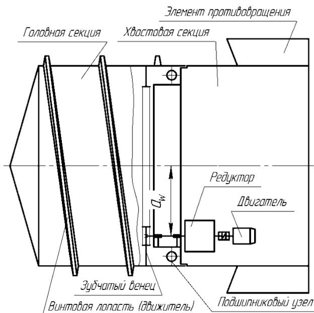
Рис. 1. Кинематическая схема трансмиссии геохода с редукторным приводом
