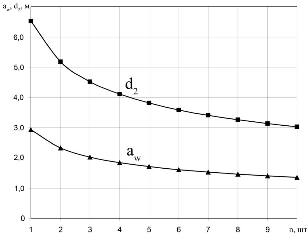
**Рис. 2.** Зависимости межосевого расстояния передачи  $a_w$  и диаметра делительной окружности зубчатого венца  $d_2$  от количества потоков передачи мощности –  $n$
