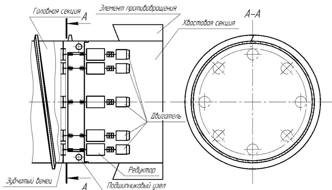
**Рис. 4.** Кинематическая схема трансмиссии геолохода с многопоточным редукторным приводом
