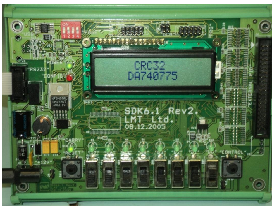
Рис. 5. а) Окно ввода данных терминала term_1b с ПК на макет; б) макет SDK-6.1 с контрольной суммой CRC32 для сообщения «qwerasdfzxcvbnm,» на дисплее
