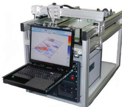
Рис. 2. Стационарная система IDEalSystem3D для ультразвукового контроля
