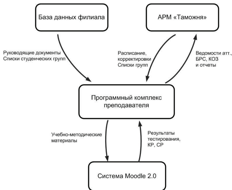
Рисунок. Принципы построения программного комплекса преподавателя
