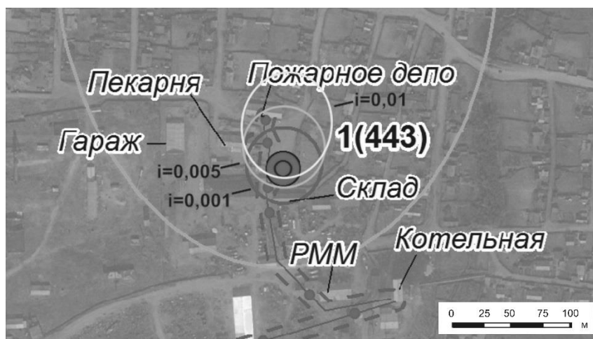
Рисунок 1 – Схема расположения хозяйственных объектов и поясов ЗСО 2-го порядка при разных значениях уклона фильтрационного потока
