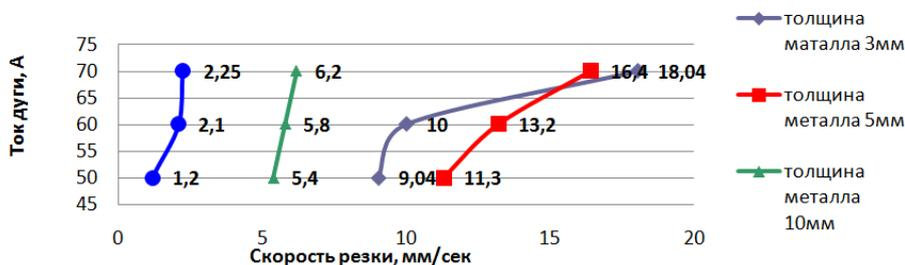
Рис. 1. Влияние тока дуги на скорость резки (Автоматическая резка, давление плазмообразующего газа (воздух) 6 кгс/см)
