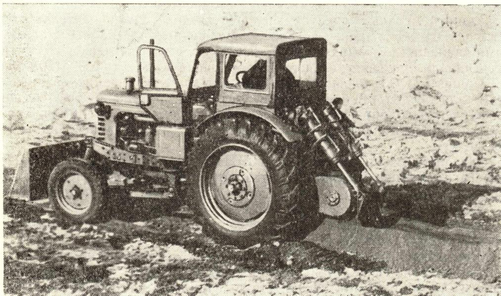
Рис. 5. Баровая землерезная машина БЭТН.
