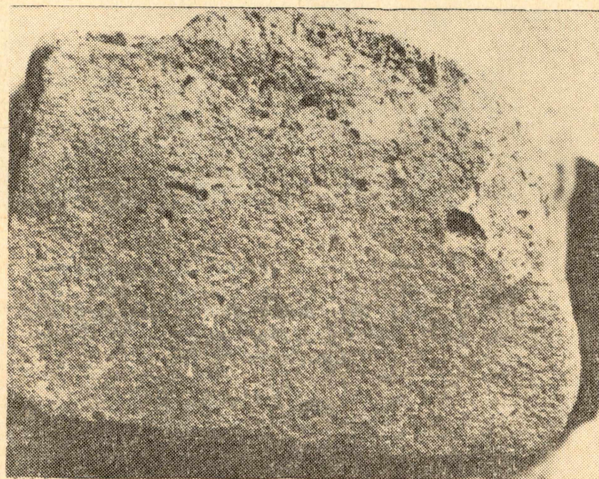
Рис. 4. Суглинок лёссовидный, рыхлого сложения. Верхний лёссовый горизонт. Шурф № 355, глубина 2,5 м. Склон водораздела.
