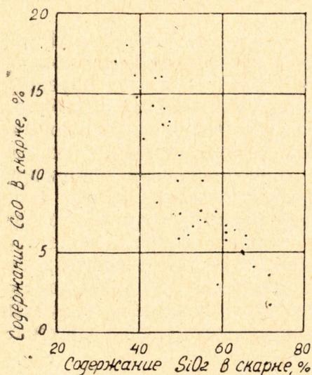
Рис. 3. График зависимости содержания в скарнах  $\text{CaO}$  от содержания в них  $\text{SiO}_2$ .
