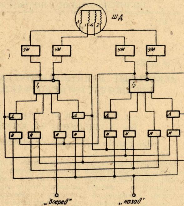
Рис. 1. Функциональная схема блока управления шаговым двигателем.
