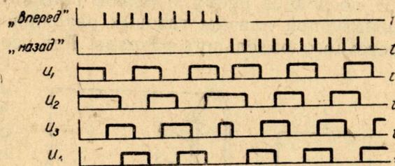
Рис. 2. Временная диаграмма напряжений на фазах шагового двигателя.
