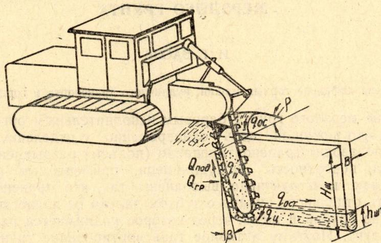
Рис. 1. Схема циркуляции штыба во врубной щели при резании мерзлого грунта баровой машиной
