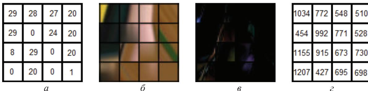
**Рис. 8.** Иллюстрация эффективности сжатия блоков при выборе из всех режимов внутреннего предсказания: а) режим внутреннего предсказания для данного блока; б) предсказанные блоки; в) блоки после вычитания предсказываемого и предсказанного блоков (остатки); г) соответствующие размеры сжатых блоков, бит
