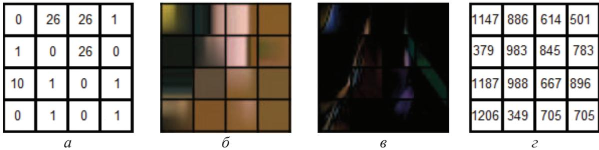
**Рис. 10.** Иллюстрация эффективности сжатия блоков при выборе из всех режимов внутреннего предсказания, доступных в H.265/AVC для блоков размером 16×16: а) режим внутреннего предсказания для данного блока; б) предсказанные блоки; в) блоки после вычитания предсказываемого и предсказанного блоков (остатки); г) соответствующие размеры сжатых блоков, бит
