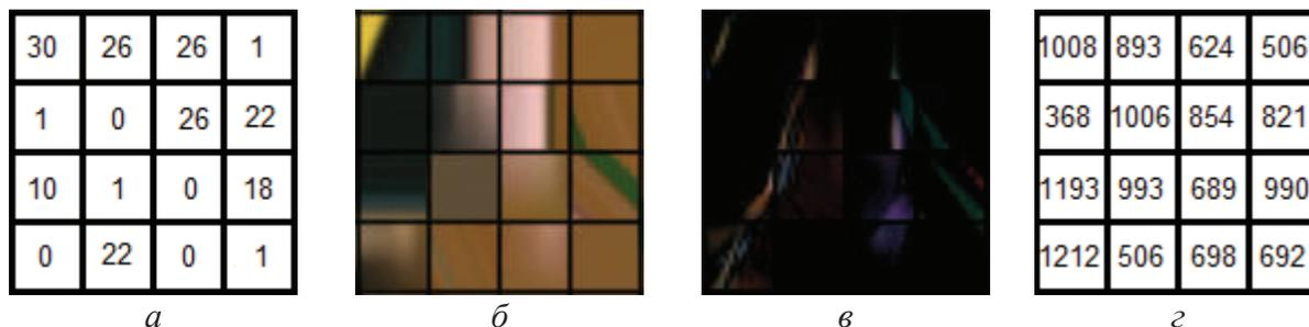
**Рис. 9.** Иллюстрация эффективности сжатия блоков при выборе из всех режимов внутреннего предсказания, которые были в H.265/AVC: а) режим внутреннего предсказания для данного блока; б) предсказанные блоки; в) блоки после вычитания предсказываемого и предсказанного блоков (остатки); г) соответствующие размеры сжатых блоков, бит
