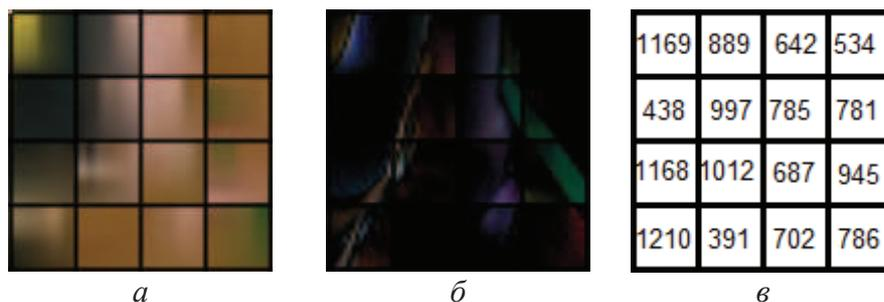
**Рис. 7.** Иллюстрация эффективности сжатия блоков при плоском режиме внутреннего предсказания: а) блоки, предсказанные плоским режимом; б) блоки после вычитания предсказываемого и предсказанного блоков (остатки); в) соответствующие размеры сжатых блоков, бит
