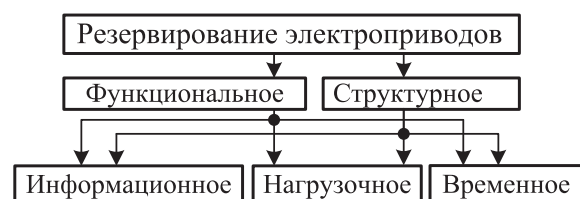
Рис. 1. Связь видов резервирования в обеспечении отказоустойчивости электроприводов
