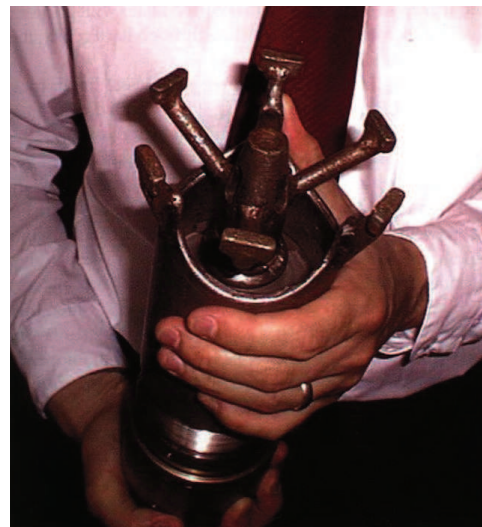
Рис. 4. Буровой наконечник для проходки скважин сплошного забоя электроимпульсным способом [18]
