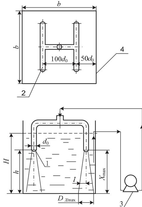
Рис. 3. Устройство для перемешивания струйным методом: 1) вертикальные сопла (4 шт.); 2) трубная гребенка для сопла; 3) насос; 4) емкость
