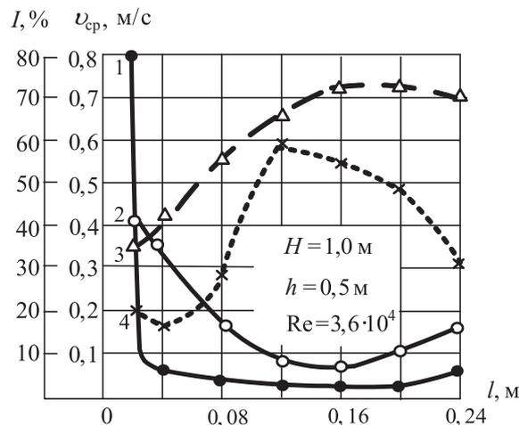
Рис. 4. Распределение скоростей истечения жидкости и интенсивности турбулентности в зависимости от расстояния от оси сопла: 1)  $h_0=0,5$  м; 2)  $h_0=0,15$  м; 3) интенсивность турбулентности; 4)  $h_0=0,05$  м
