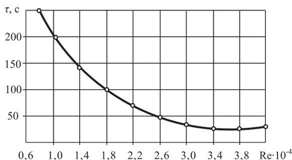
**Рис. 1.** Зависимость времени перемешивания от критерия Рейнольдса
