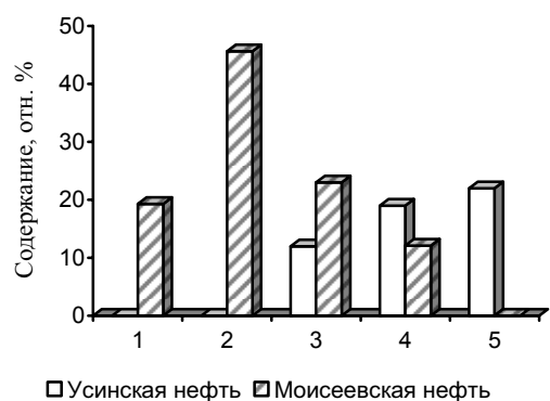
Рис. 2. Групповой состав ароматических амидов нефтей: 1) пиридоны ( z=7-9 ); 2) хинолоны ( z=11-15 ); 3) бензохинолоны ( z=17-21 ); 4) дибензохинолоны ( z=23-27 ); 5) трибензохинолоны ( z=29-31 )
