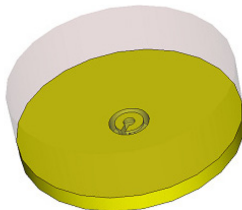
Рис. 1. Внешний вид модели накладного измерительного датчика нерезонаторного типа для измерения на проход
