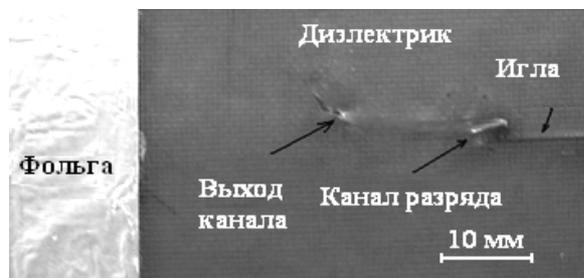
Рис. 5. Вид канала разряда в композиции ПММА – имидофлекс в системе электродов типа Б
