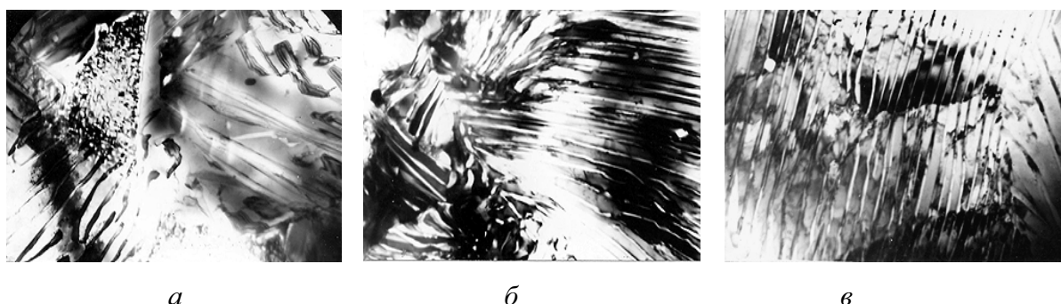
Рис. 6. Структура сплава 47XNM после закалки от 1250 °С, 1 мин и старения при 700 °С, 10 ч: а) \times 8500 ; б) \times 8000 ; в) \times 13000
