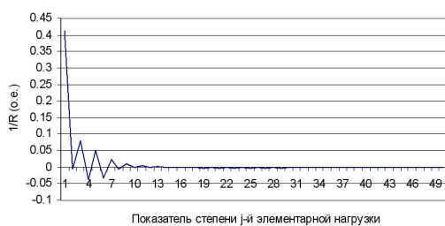
Рис. 5. Значения величины 1/R_j , полученные в результате минимизации целевого функционала
