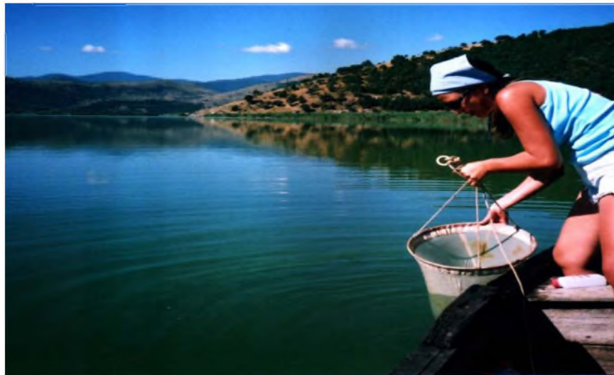
Εικόνα 1.6. Συλλογή συμπυκνωμένου υλικού με πλαγκτοσυλλέκτη (διάμετρος πόρων 30 \mu\text{m} )
