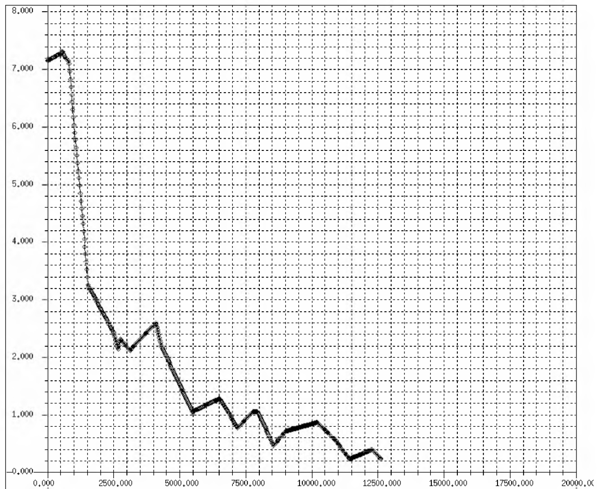
Σχήμα 34. Συγκέντρωση των νιτρικών (mg/l) στα υπόγεια ύδατα του Ν. Ροδόπης (κατά μήκος της τομής 7 - Οκτώβριος 2006)
