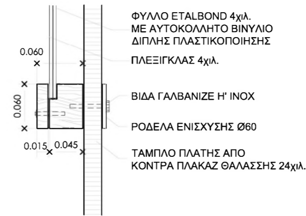
ΛΕΠΤΟΜΕΡΕΙΑ ΣΤΗΡΙΞΗΣ ΠΙΝΑΚΙΔΑΣ ΜΕ ΞΥΛΙΝΟ ΑΠΟΣΤΑΤΗ
