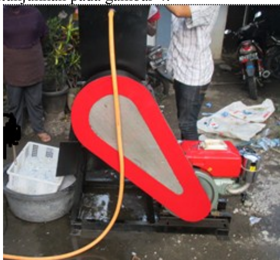
Gambar 4. Hasil rancang bangun mesin penghancur limbah plastik sistem knock down
