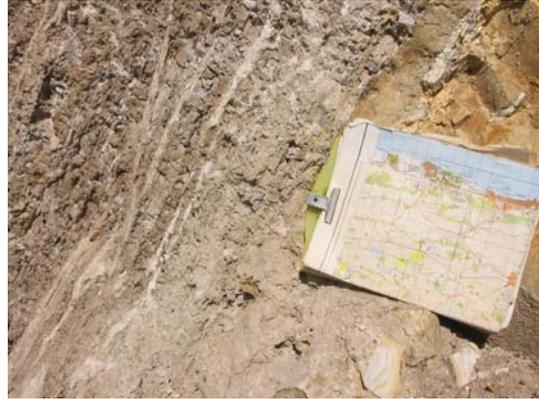
Foto 4: Vistas en detalle de las secuencias flyshchoides compuesta por repeticiones de argilitas y arcillas de color achocolatada y areniscas polimícticas de la misma tonalidad (Formación Vía Blanca) en la cantera anteriormente señalada.
