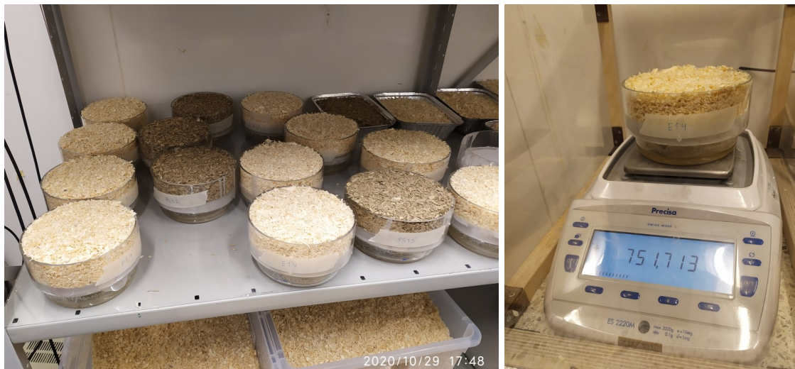
Kuva 4.16 Ensimmäisen koesarjan 50–95 % RH kosteusparin kuppeja olosuhdehuoneessa.
