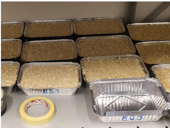
Kuva 4.7 Tasapainokosteuskoekappaleita valmistettuna, etualalla tyhjiä astioita.
