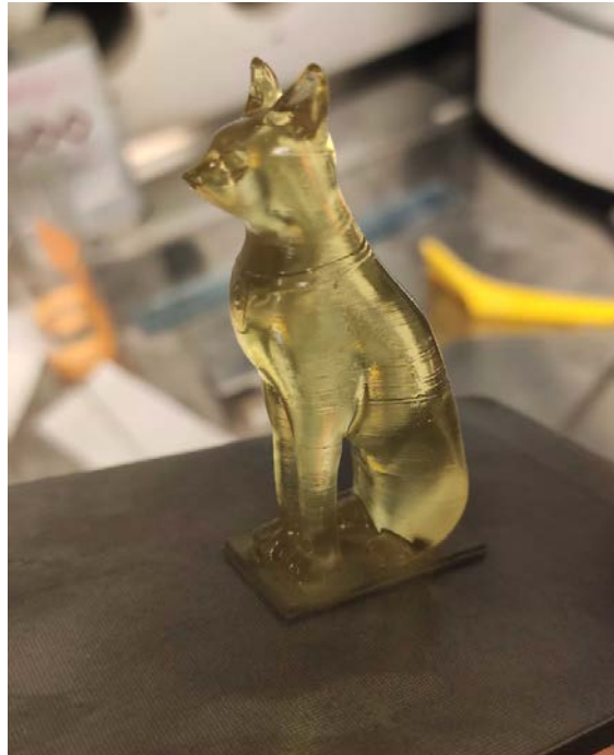
Kuva 36. Keraamilietteen pohjana käytetyllä akryylilietteellä tulostettu suurempi kappale (~10 ml). Kerrospaksuus 50 \mu\text{m} , pohjakerroksen valotus 8 s ja muut kerrokset 1,5 s.
