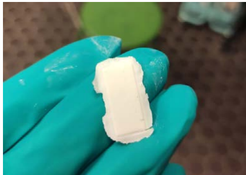
Kuva 34. Tulostusaltaan pohjaan kiinnittynyt jäännös. Suorakulmion ääriviivojen ympärillä näkyy ylimääräinen leviämä. Käytetyn lietteen alumiinioksidipitoisuus oli 12,5 til-%.
