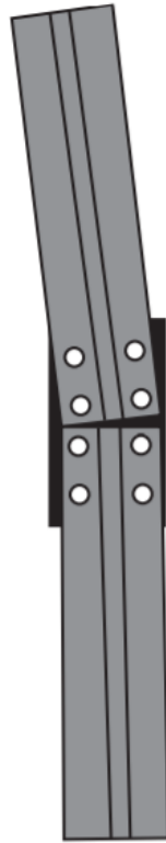
Kuva 2.7. Johdejatkoslevyn virheellinen asennus [8, s. 82]
